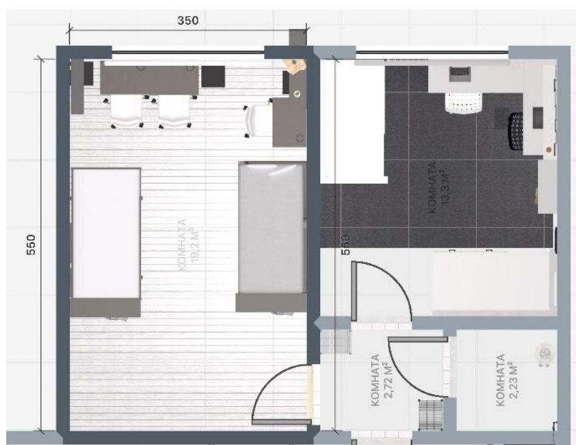
Рисунок 5. – План-схема жилой ячейки II типа
