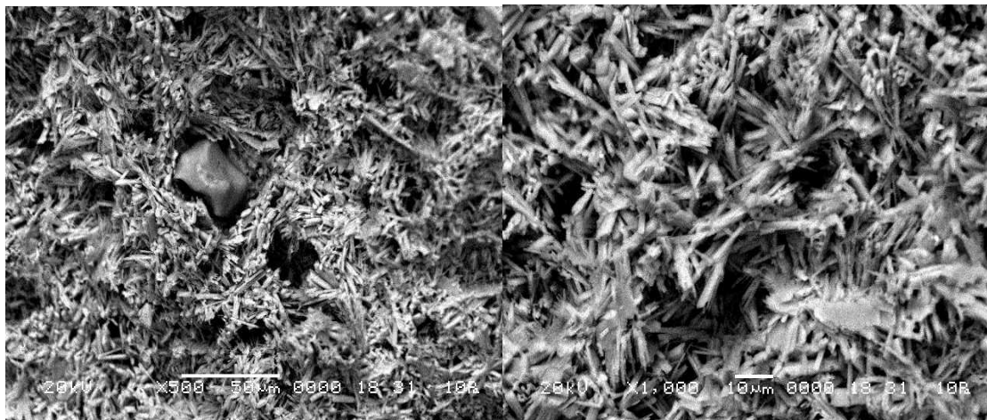
Рисунок 5.2 – Электронная микроскопия гипсового камня, модифицированного шламом водоподготовки (5% от массы вяжущего) при увеличении 500 крат (а) и 1000 крат (б)
