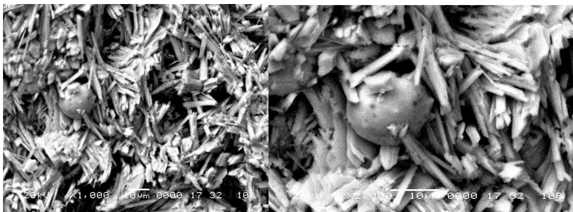
Рисунок 6.2 – Электронная микроскопия гипсового камня, модифицированного байпасной пылью (5% от массы вяжущего) и шламом (15% от массы вяжущего) при увеличении 1000 крат (а) и 2000 крат (б)
