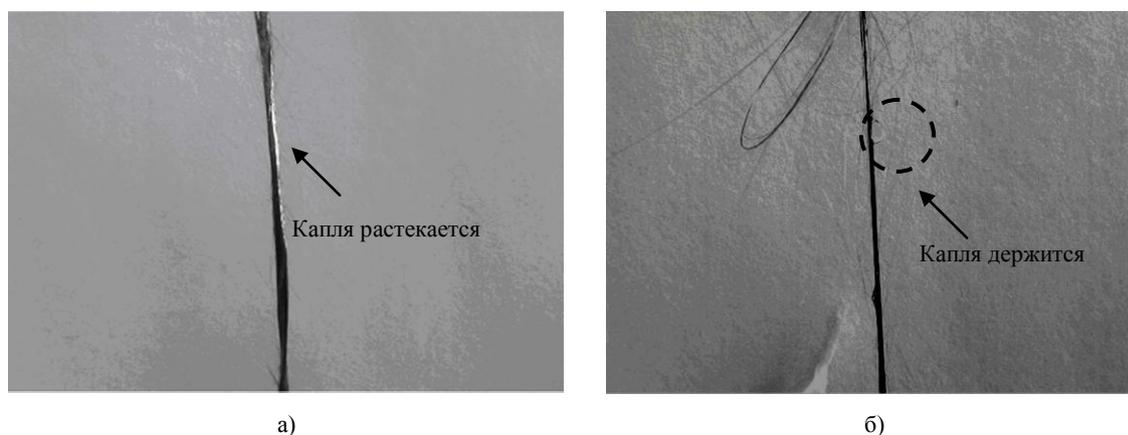
Рис. 1. Смоченная поверхность исходного образца углеволокна (а) и волокна после ионно-лучевой обработки в среде аргона в течение 20 минут (б)
