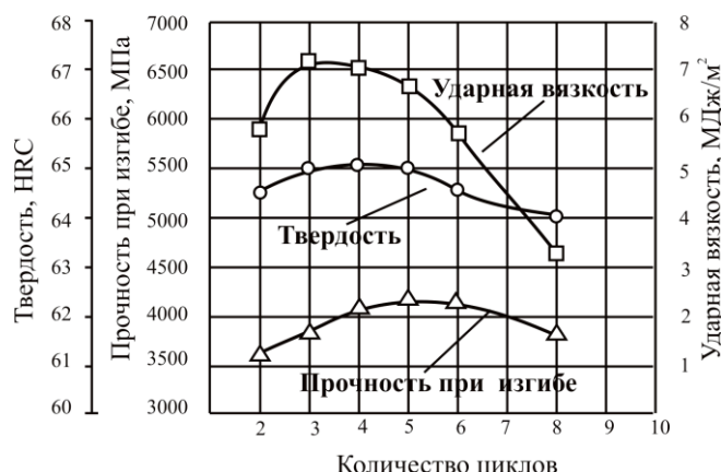
Рис. 2. Влияние количества циклов при УТЦО на свойства быстрорежущей стали Р6М5.
