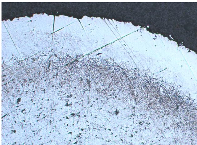
Рис. 4. Микроструктура проволоки, подвергнутой диффузионному насыщению титаном, \times 200
