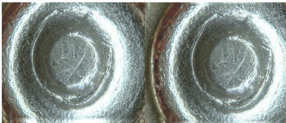
Рис. 1. Фотоснимок совмещения профилей следов полей нарезов канала ствола на двух пулях, изъятых при осмотре двух различных мест происшествий, но выстреленных из одного образца огнестрельного оружия
