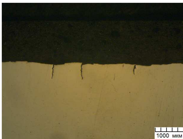
Рисунок 2. – Трещины КРН в поперечном сечении основного металла трубы (начальная стадия)
