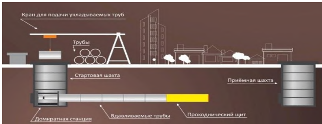
Рисунок 3. Микротоннелирование
