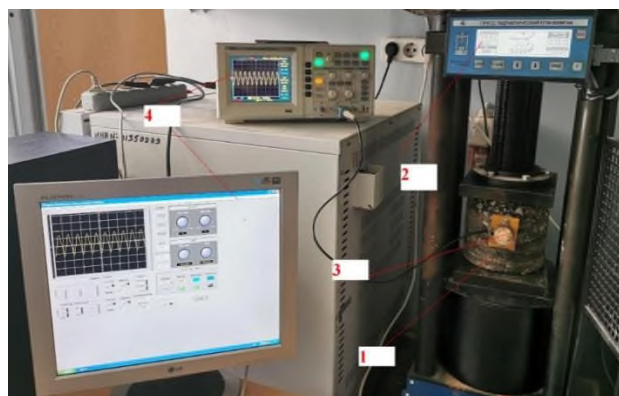
Рисунок 3 – Внешний вид экспериментального оборудования: 1 – образец из асфальтобетона, 2 – пресс гидравлический, 3 – пьезодатчик, 4 – АЭ комплекс
