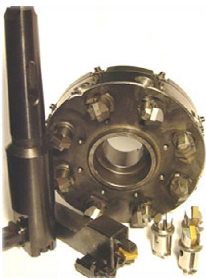
**Рисунок 5.7. – Гамма блочно-модульных режущих инструментов**
