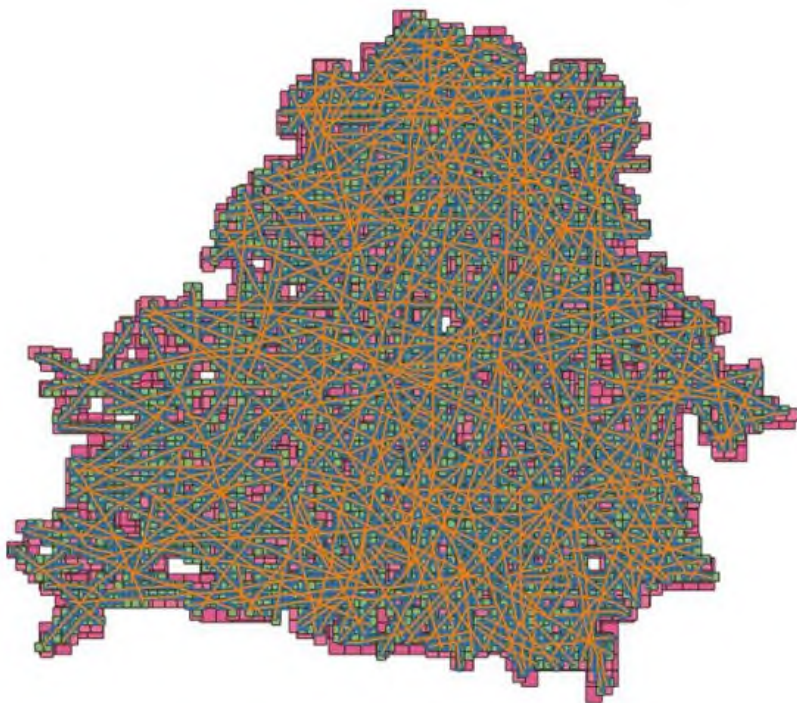
Рис. 1. Разломная сеть Беларуси, покрытая набором регулярных сеток с различными размерами ячеек [1]
