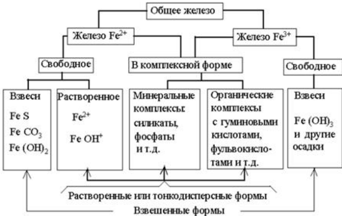
Рисунок 1.1 Схемы существования различных форм железа в воде
