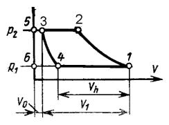
Зависимость между давлением рабочего тела в цилиндре поршневого компрессора и занимаемым им в данный момент объемом, называется индикаторной диаграммой.
