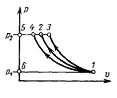
В первом случае стенки компрессора идеально теплонепроницаемы. Тогда процесс сжатия будет адиабатным и техническая работа в  ${\it PJ}$ -диаграмме изобразится площадью
