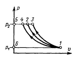
В идеальном компрессоре происходит процесс политропного сжатия рабочего тела, изображаемый в  $P^{J}$ -диаграмме линией 1-2, причем техническая работа  $I_{m}$ , затрачиваемая нежатие, является величиной отрицательной и изображается площадью 1-2-5-6-1.
