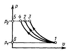
В другом случае стенки компрессора идеально теплопроводны, и температура потока остается постоянной. Тогда процесс сжатия будет изотермическим, а техническая работа в  $^{pJ}$ -диаграмме изобразится площадью  $^{1-4-5-6-1}$ , и может быть найдена из выражения технической работы потока:
