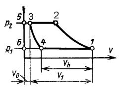
Отношение  $h_{o\delta} = V_h / V_1$  является называется *объемным к.п.д.* компрессора. Чем выше конечное давление, тем меньший объем занимает газ в конце сжатия, а в пределе, когда конечный объем газа уменьшается до  $V_0$ , производительность компрессора становится равной нулю. В этом случае находящийся в компрессоре газ
