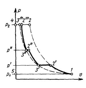
Из  $^{pJ}$ -диаграммы, в которой в качестве примера изображен рабочий процесс трехступенчатого компрессора, видно, что промежуточное охлаждение рабочего тела существенно уменьшает затрату технической работы (пл.  $1-2^{l}-3^{l}-2^{ll}-4-5-1 < пл. 1-2-4-5-1$ ) и приближает процесс сжатия к изотермическому (линия  $1-3^{l}-3^{ll}-3^{ll}$ ).
