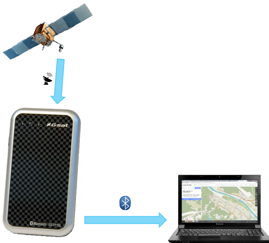
Рис. 1. Схема обмена данными между GPS-приемником и компьютером.
