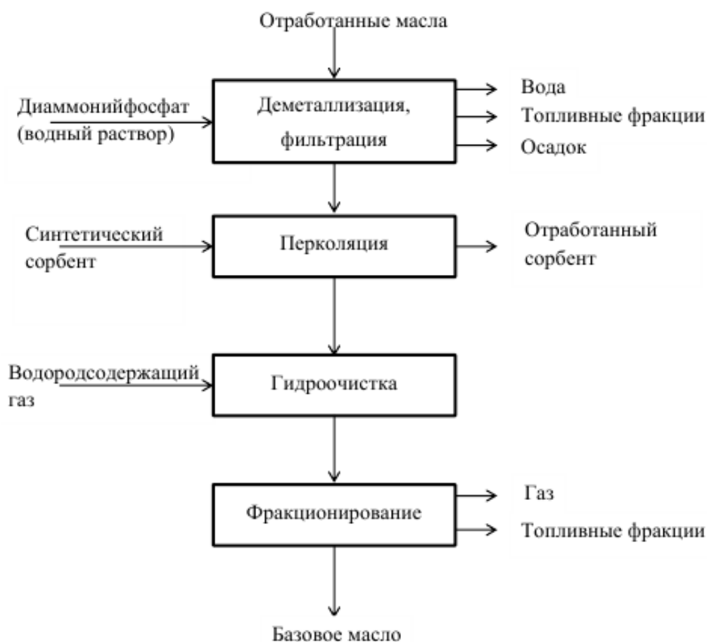
Рисунок 5.1. – Схема процесса PROP
