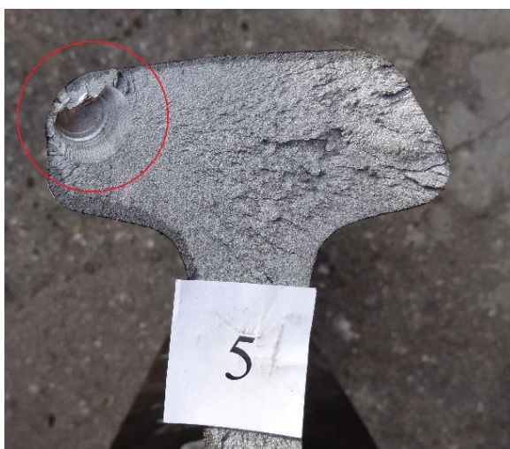
Рисунок 1.1 - Поперечная трещина головки рельса
