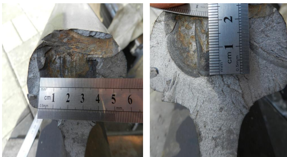
Рисунок 2.22 – Результаты долома образца №1
