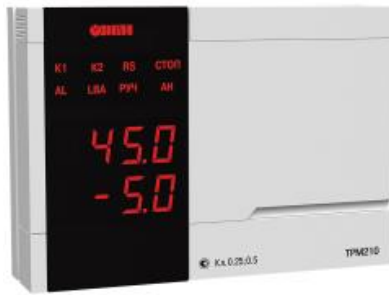
Рисунок 6.2 - Внешний вид контроллера TRM 210
