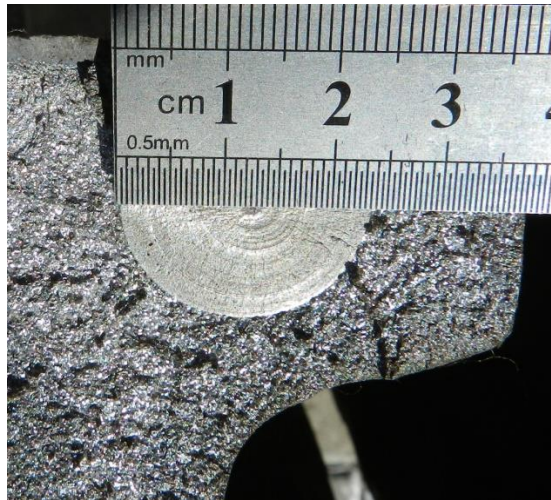
Рисунок 2.25 – Результаты долома образца №4
