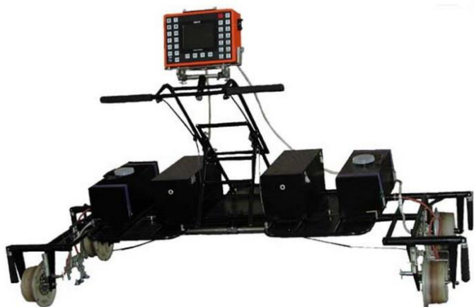
Рисунок 1.18 - Ультразвуковой дефектоскоп УДС2-РДМ-22
