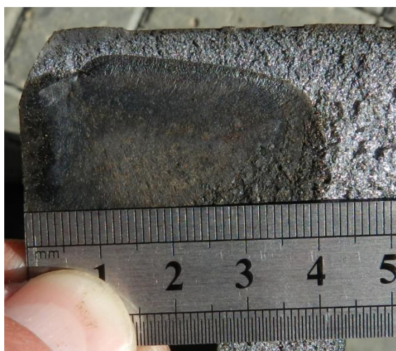
Рисунок 2.24 – Результаты долома образца №3
