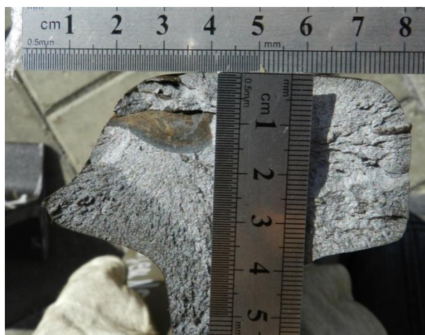
Рисунок 2.23 – Результаты долома образца №2
