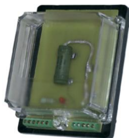
Рисунок 6.5 - Внешний вид эмулятора печи ЭП-10
