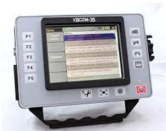
Рисунок 1.21 - Внешний вид дефектоскопа УДС2М-35
