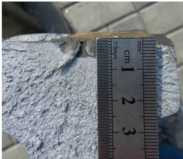
Рисунок 2.26 – Результаты долома образца №5
