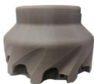
Рисунок 1.8.2 – Макеты корпусов БМФ в виде сочетания диска, усеченного конуса и цилиндра (а и б), сопрягаемых торов (в)
