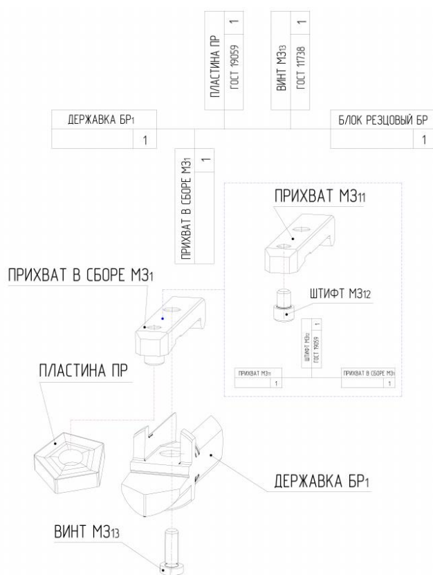
Рисунок 1.5.1. – Технологическая схема сборки блока резцового
