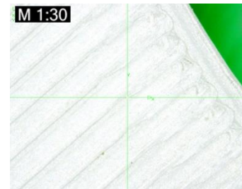
Рисунок 1.2.14. – Эскиз БМРИ и экспериментальная установка измерения его геометрических параметров (а) и структура наружной поверхности, напечатанных: б – из пластика ABSplus-P430 на 3D принтере Stratasys Mojo; в – из PLA-пластика Wanhao на 3D принтере Mass Portal Pharaoh XD 30
