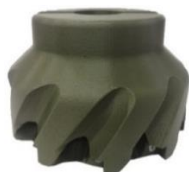
Рисунок 1.8.2 – Макеты корпусов БМФ в виде сочетания диска, усеченного конуса и цилиндра (а и б), сопрягаемых торов (в)
