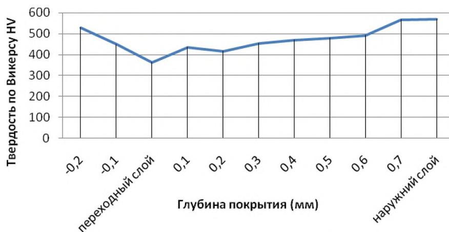
**Рисунок 2.13 – Распределение микротвердости по наплавленному слою порошком ИЧХ18**
