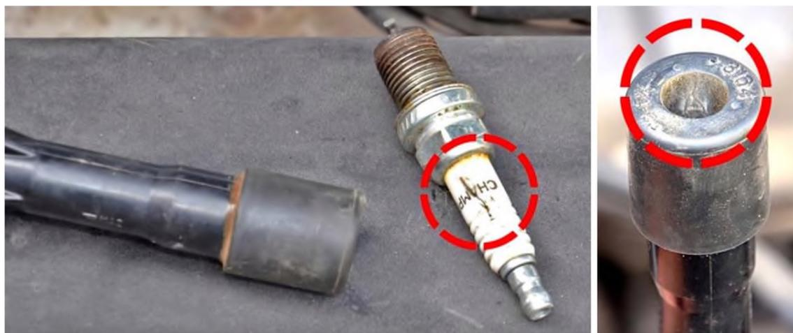
**Рисунок 1.11. Пробитая по изолятору свеча зажигания и ее высоковольтный наконечник.**
