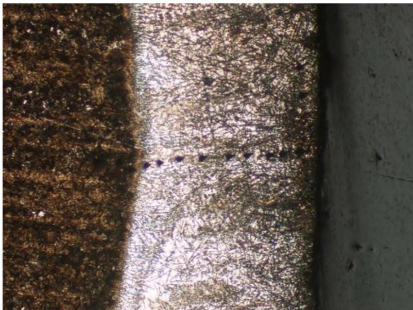
**Рисунок 2.14 – Проведение анализа микротвердости**
