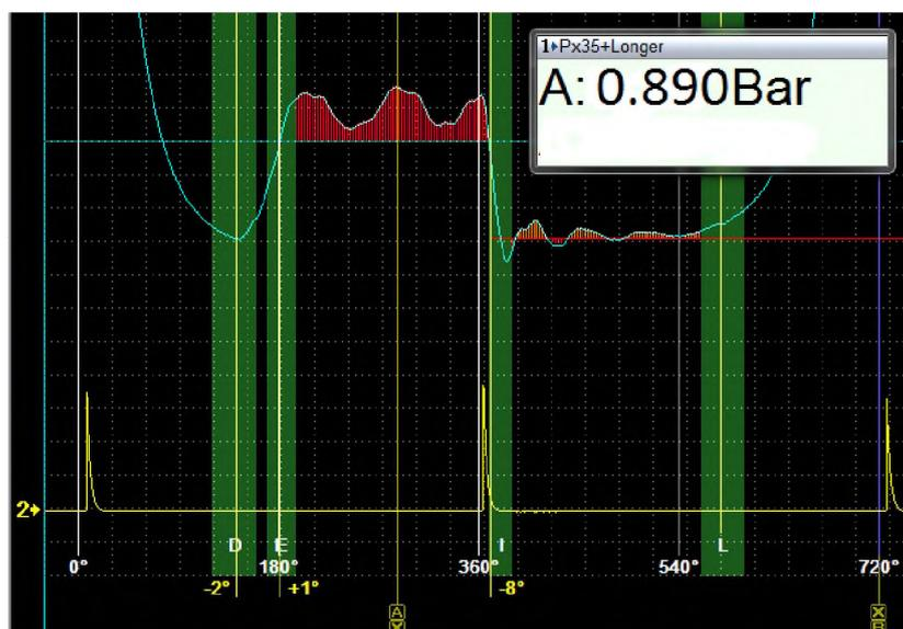
**Рисунок 1.16. Осциллограмма давления газов в цилиндре автомобиля Fiat Marea 1,6 1996 г.**
