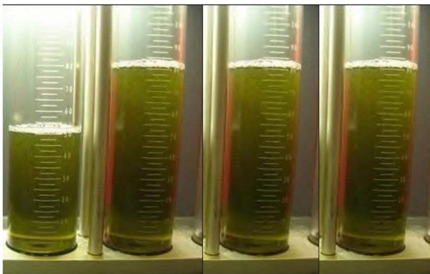
**Рисунок 1.5. Проверка форсунок на стенде. Низкая производительность форсунки 1-ого цилиндра.**
