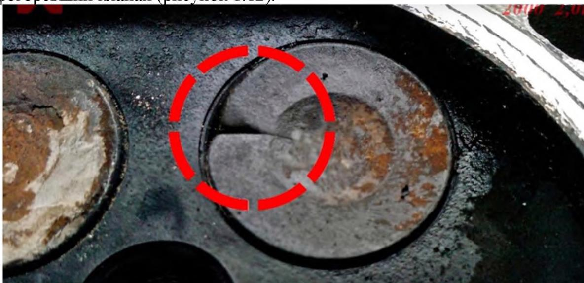
**Рисунок 1.12. Прогоревший клапан.**
