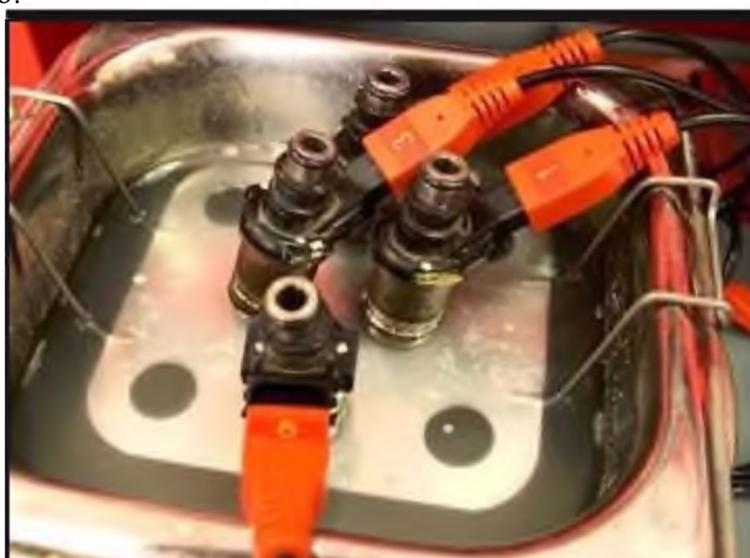
**Рисунок 1.6. Промывка форсунок в ультразвуковой ванне.**
