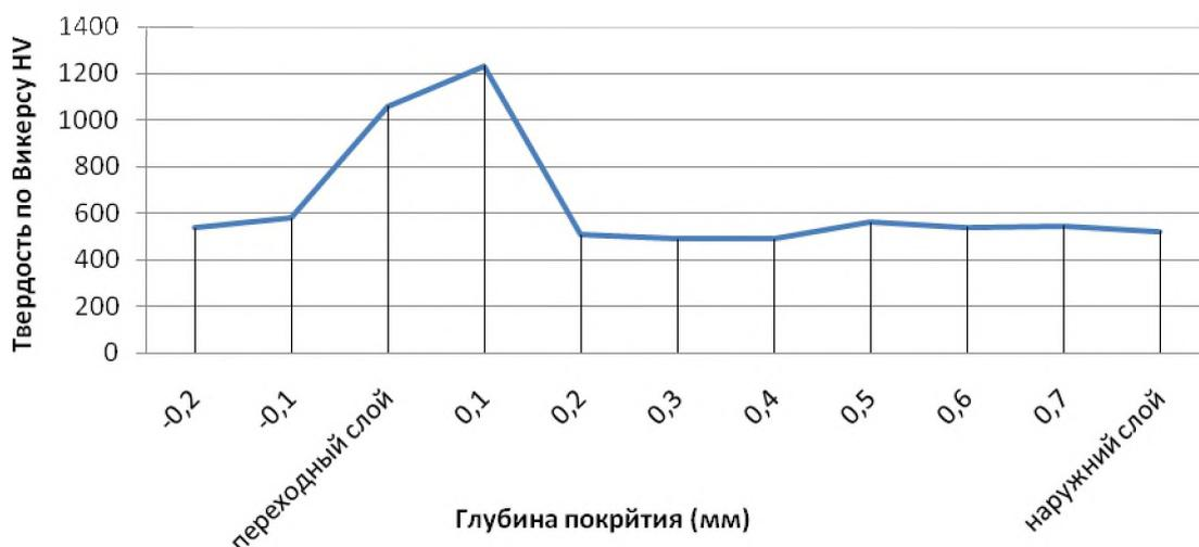
**Рисунок 2.9 – Распределение микротвердости по наплавленному слою порошком ПГ-19М-01**
