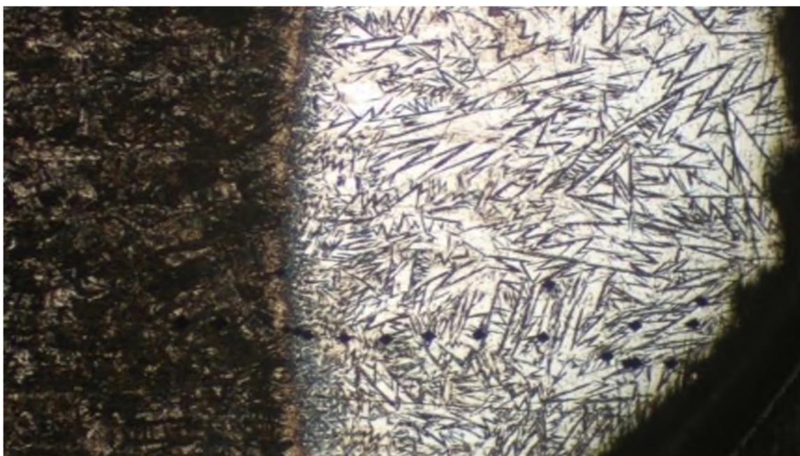
**Рисунок 2.10 – Проведение анализа микротвердости**
