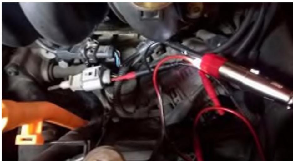
**Рисунок 1.3.. Подключение осциллографического щупа к сигнальному проводу датчика коленчатого вала.**
