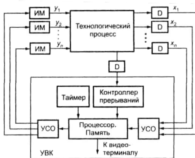
Рис. 5.13. УВК в контуре управления технологическим процессом: x_1 \dots x_n – параметры процесса; y_1 \dots y_n – управляющие воздействия; D – датчики, ИМ – исполнительные механизмы
