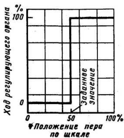
Рис. 4.19. Графическое изображение действия двухпозиционного регулятора
