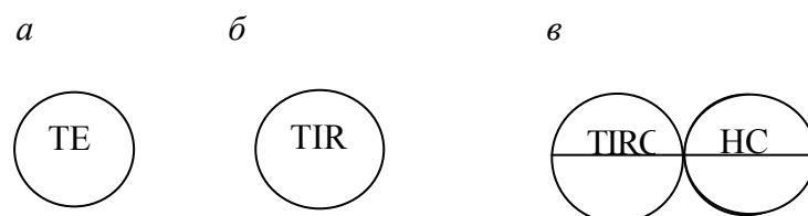
Рис. 5.15. Примеры условных изображений на функциональных схемах средств измерения и регулирования температуры: а) датчик температуры; б) показывающий и регистрирующий прибор; в) показывающий и регистрирующий прибор с регулятором, укомплектованный панелью дистанционного управления
