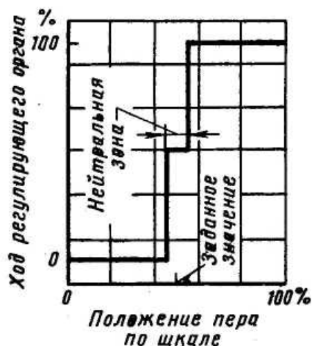
Рис. 4.20. Графическое изображение действия трехпозиционного регулятора
