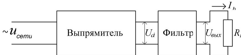
Рис. 12.9. Подключение сглаживающего фильтра
