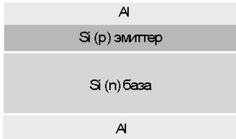
Рис. 4.5. Конструкция перехода, изготовленного по диффузионной технологии
