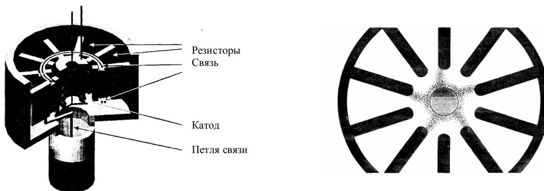
Рис. 16.12. Конструкция резонатора и траектории движения электронов в магнетроне
