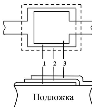
Рис. 13.10. Конструкция пленочного конденсатора
