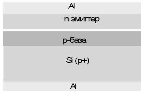
Рис. 4.6. Конструкция перехода, полученного эпитаксиальным наращиванием
