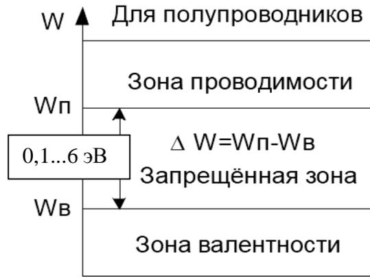
Рис. 1.8. Зонная энергетическая диаграмма полупроводников
