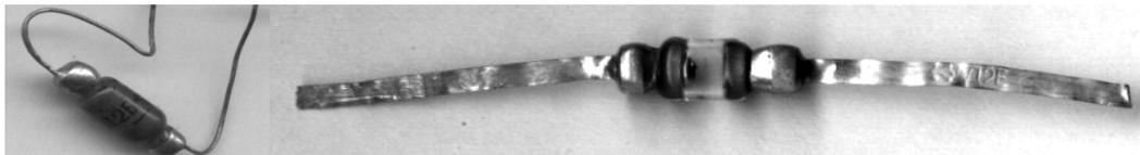
Рис. 4.28. Популярные диоды Д2 в двух вариантах исполнения
