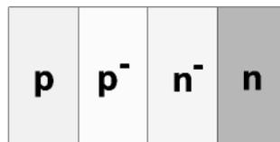
Рис. 4.20. Концентрация примесей в СВЧ диодах
