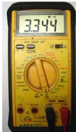
Рис. 7.19. Проверка диодов на мультиметре
