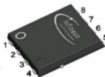
Рис. 7.24. SuperSO-8, оно же – TDSON-8. Отличается от SO-8 тем, что 4 вывода соединены с подложкой транзистора, что облегчает температурный режим
