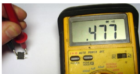
Рис. 7.20. Диагностика полевых транзисторов N-канального типа
