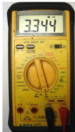
Рис. 7.19. Проверка диодов на мультиметре
