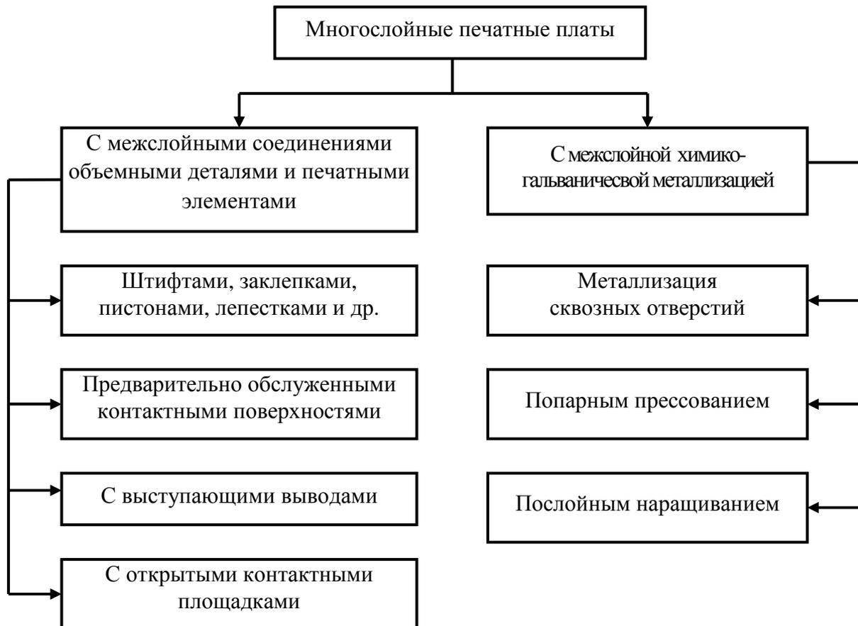
**Рис. 3.2. Классификация многослойных печатных плат**
