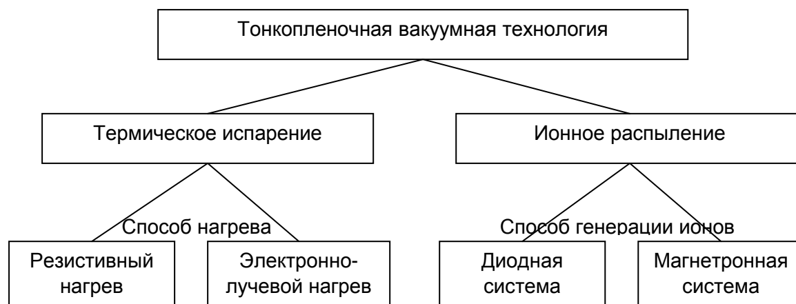
Рис. 2.1. Классификация методов получения тонких пленок по способу генерации потока частиц в вакууме
