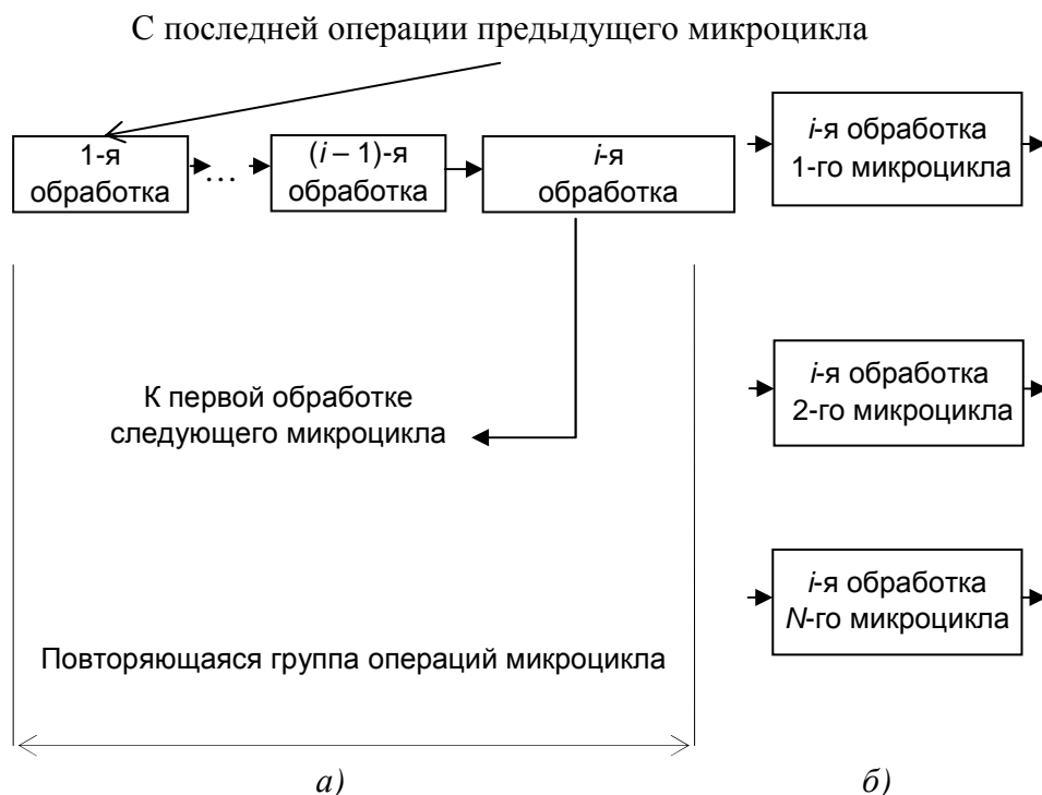
Рис. 1.61. Графическое изображение обработок одного микроцикла в виде горизонтальной строки – а ; изображение однотипных обработок нескольких микроциклов в виде вертикального столбца – б
