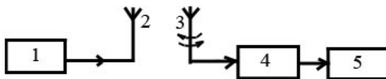
Рис. 6.7. Структурная схем для исследования ДН АВК: 1 – генератор; 2 – передающая антенна; 3 – приемная антенна; 4 – детекторная секция; 5 – индикатор
