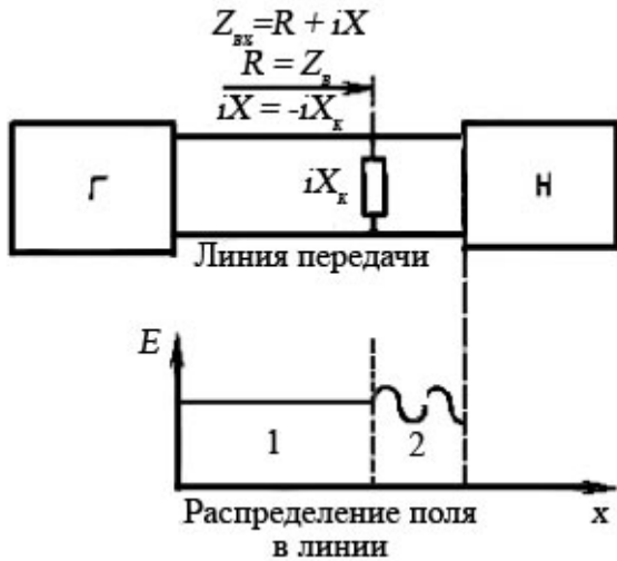
Рис. 4.4. Пояснение принципа согласования с помощью компенсирующей реактивности
