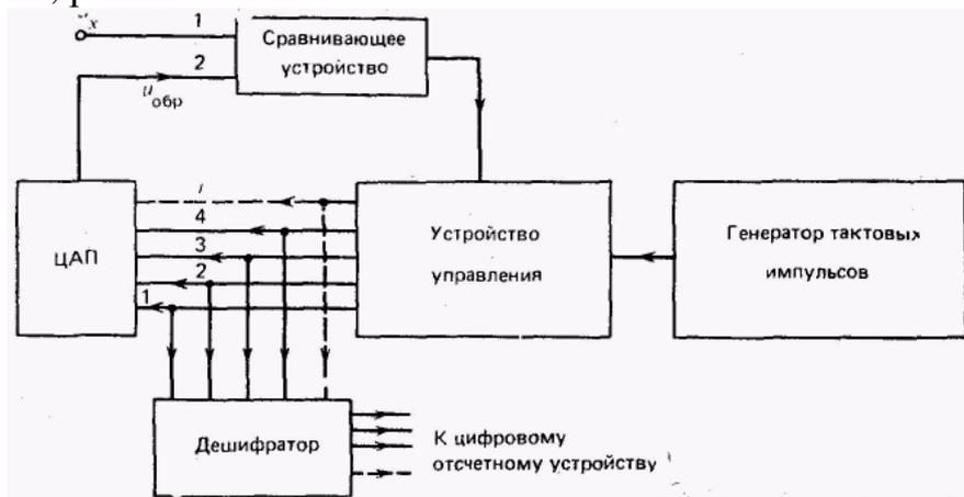
Рис. 6.14. Структурная схема АЦП поразрядного уравнивания
