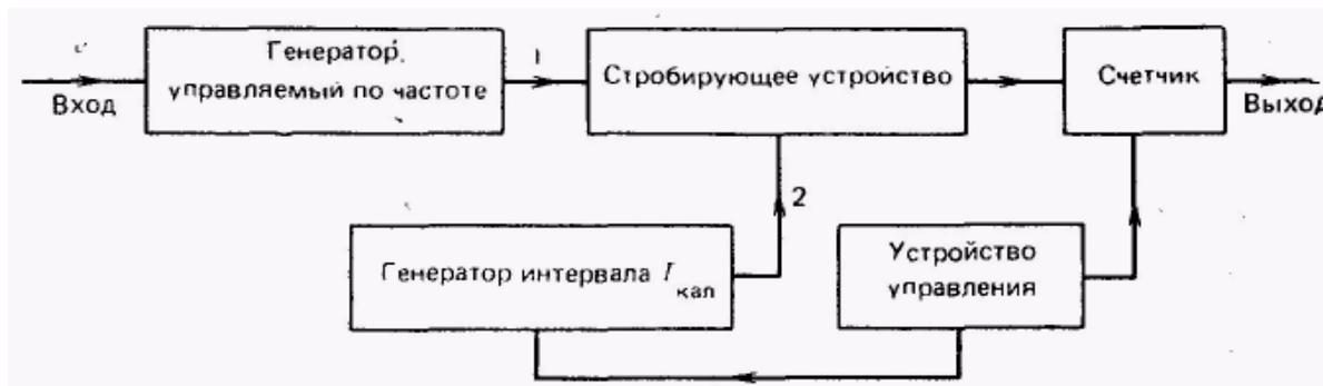
Рис. 6.11. АЦП с частотно-импульсным методом преобразования
