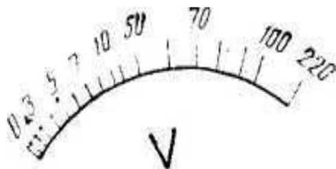
Рис. 4.1. Неравномерная шкала измерительного прибора
