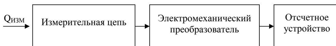
Рис. 5.1. Структурная схема электромеханического измерительного прибора
