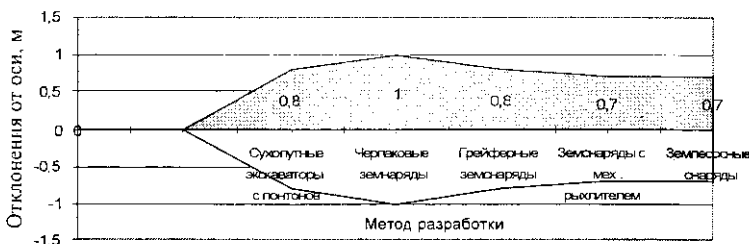
Рис. 2. Отклонения при разработке грунта \Delta_3
