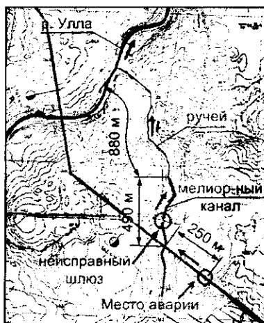
Рис. 1. Развитие аварии, произошедшей на МНПП «Унеча – Полоцк»
