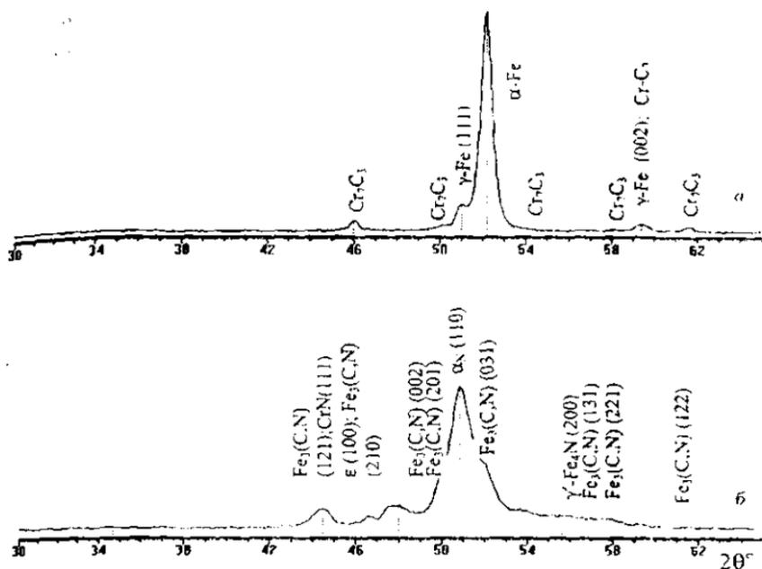
Рис. 4. Фрагменты рентгеновских дифрактограмм ( $\text{CoK}\alpha$ ) от поверхностных слоев штамповой стали фирмы «WTC», обработанной по различным режимам: а - исходное состояние (закалка+отпуск); б - имплантация N' при 720 К
