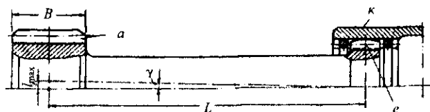
Рис. 1. Схема центральной плавающей солнечной шестерни в планетарной передаче типа 2К-Н
