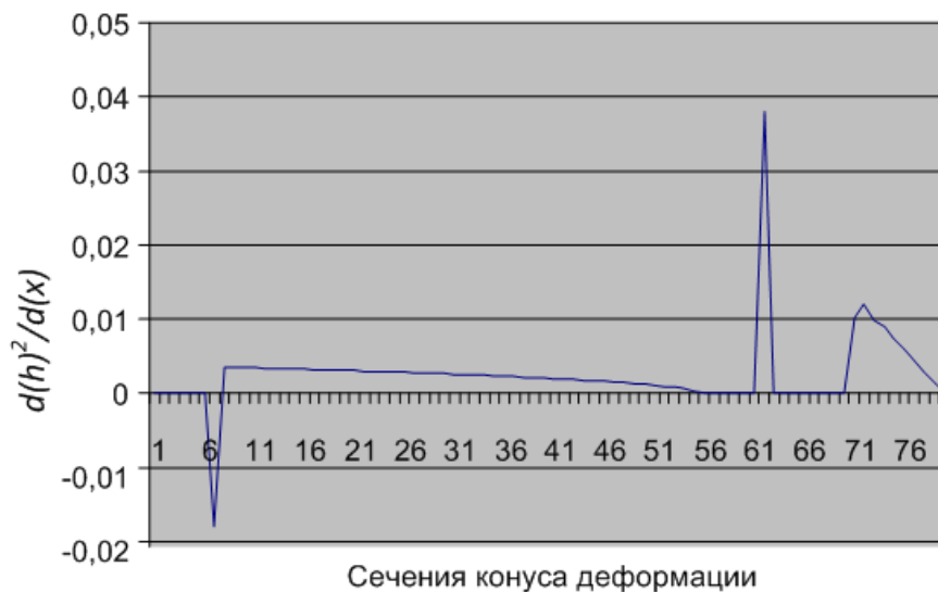
Рисунок 6.7. – График вторых производных закона изменения профиля развертки гребня ручья калибра (Gr 2, 25×3→15,1×1,8 мм, ХПТ-32)
