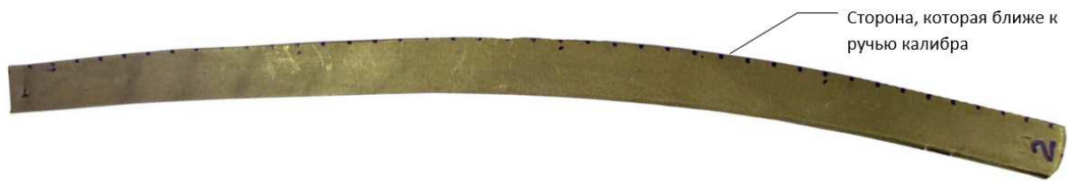
Рисунок 6.13. – Форма латунной планки после прокатки между бочками валков стана ХПТ-55 (труба из стали 20, маршрут 57×4,0→30×2,0, m = 6 мм, прямой ход клетки)
