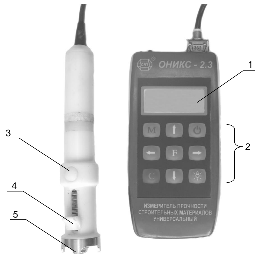
Рис. 1.6. Ударно-импульсный прибор «ОНИКС 2.3»:
