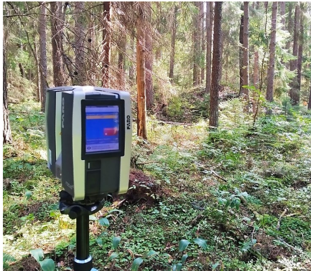
Рисунок 5. – Сканер FARO Focus 3D 120s. Процесс сканирования курганный насыпи № 3. Вид с севера
