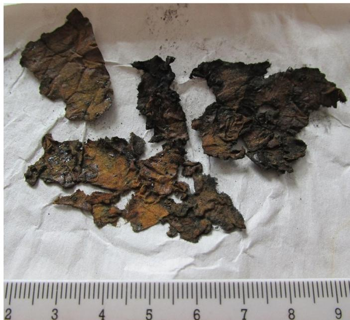
Рисунок 14. – Остатки бумажного пыжа и пороха из ствола
