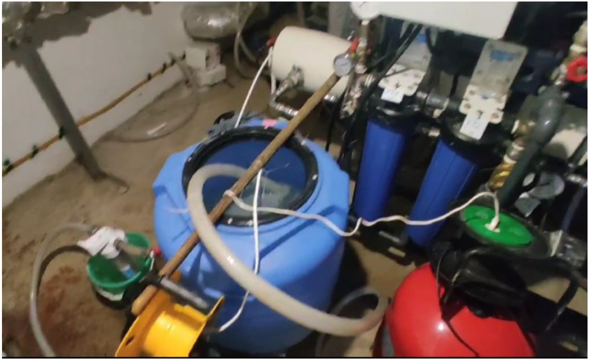
Рисунок 4.4 - Химическая регенерация мембран. Нагрев кислотного раствора pH=2,2 до 30 °С
