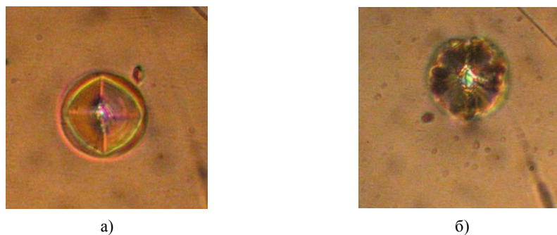
Рис. 1. Снимки характерных отпечатков индентора при индентировании в исходные (а) и имплантированные флюенсом 5 \cdot 10^{16} \text{ см}^{-2} (б) структуры фотополимер – кремний
