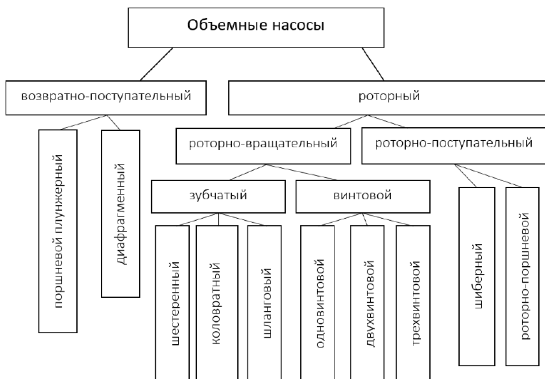
Рисунок 7.1. – Классификация объемных насосов
