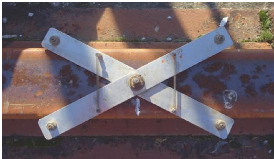
Рисунок 1. – Устройство типа «ножниц» для разметки центра рельса на их верхней части (головке)
