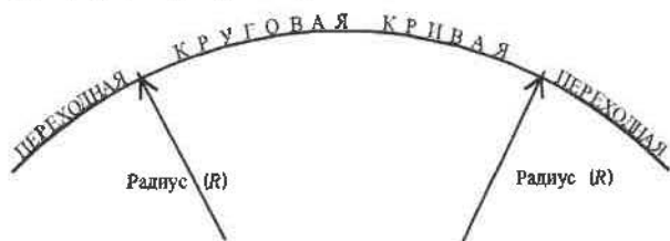
Рисунок 2 – Схема закругления с переходными кривыми
