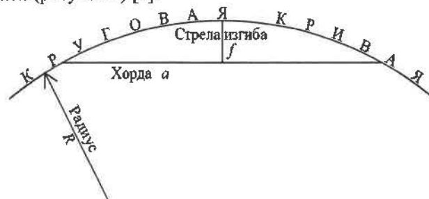
Рисунок 1 – Универсальная схема использования способа хорд
