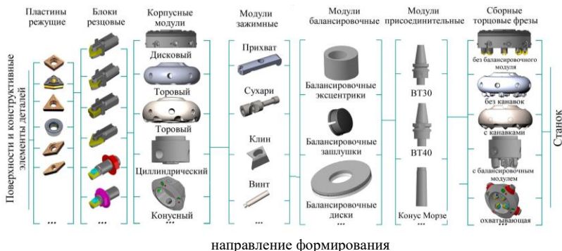
Рисунок 1. – Конструктивные элементы сборных торцовых фрез
