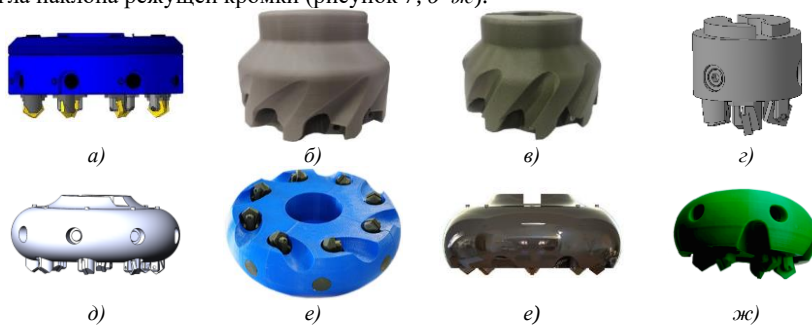
Рисунок 7. – Экспериментальные конструкции сборных торцовых фрез в форме диска (а), диска и конуса (б и в), цилиндра (г) и тора (д–ж)
