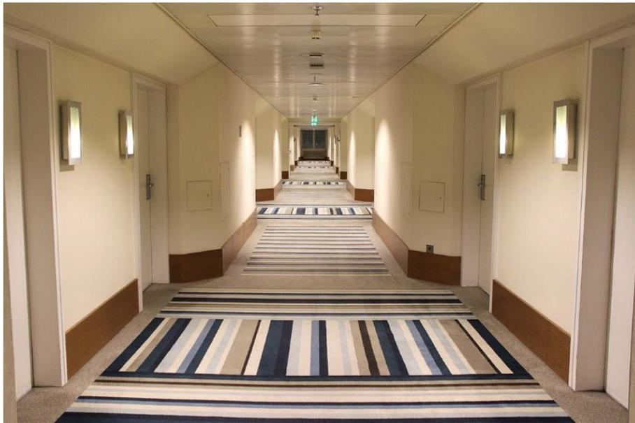
**Рисунок 3.7. – Защита от шума гостиничного коридора за счет его архитектурно-планировочного решения и звукопоглощающих ковров**
