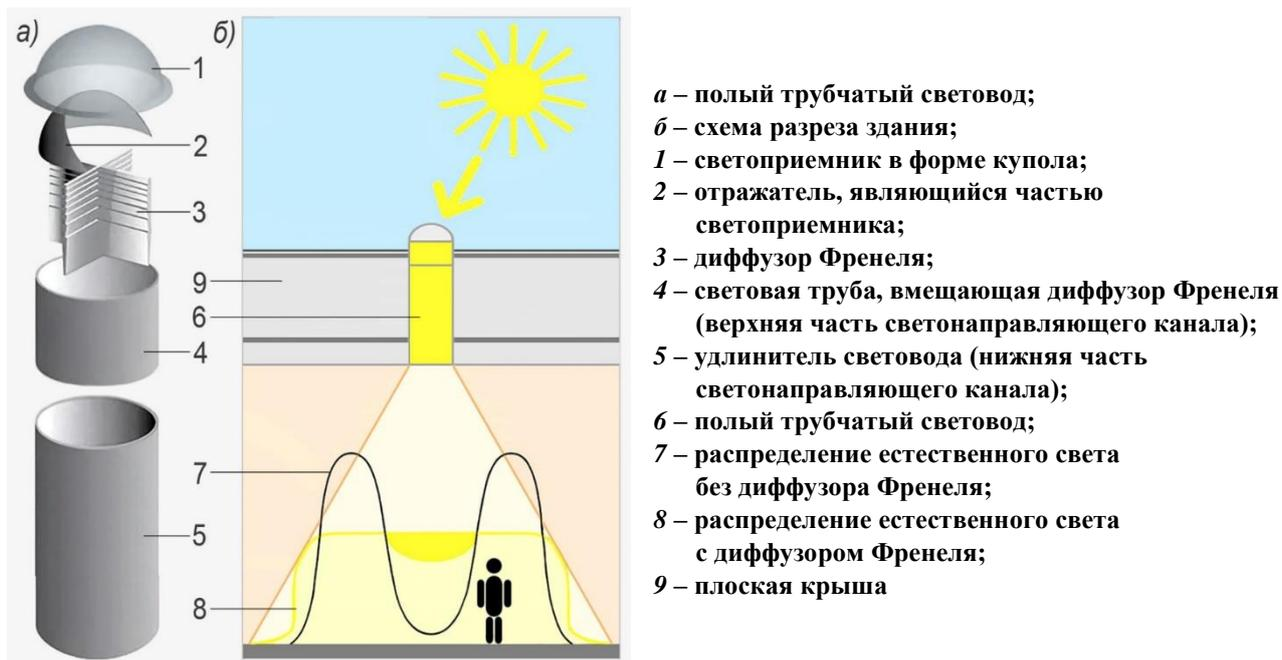
Рисунок 4.24. – Использование полого трубчатого световода диаметром 1 м в здании типа терминала аэропорта
