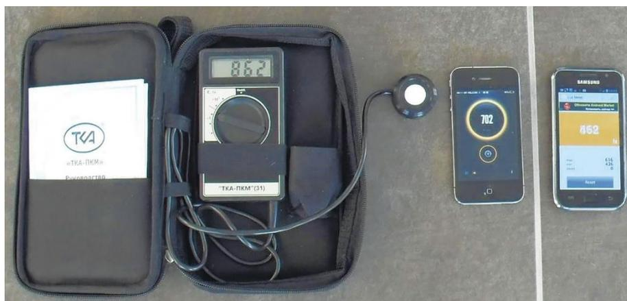
Рисунок 4.16. – Люксметры, использованные для мониторинга световой среды мультикомфортного дома в г. Дзержинске Минской области (фото архитектора А. В. Кучерявого)
