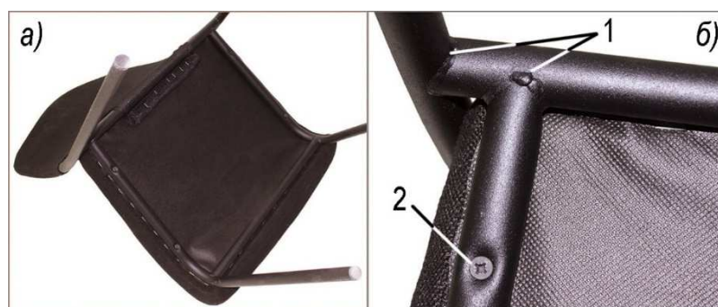
а, б – аудиторный стул; 1 – сварные швы; 2 – винт или шуруп
