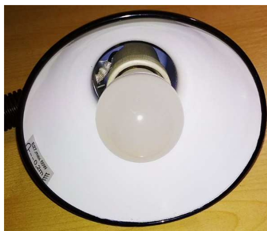
Рисунок 5.3. – Пример стандартизации: светодиодная лампочка без проблем вкручивается в соответствующий ее цоколю патрон
