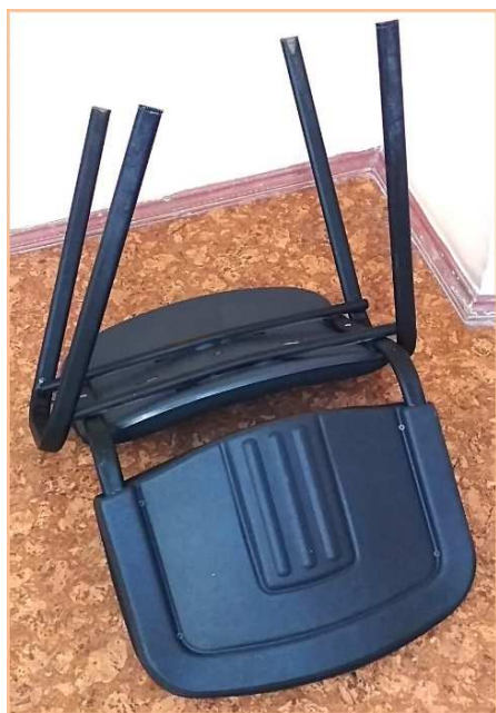
Рисунок 2.1. – Стул, в котором произошло разрушение сварных соединений
