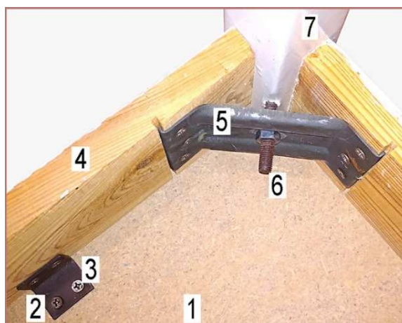
1 – столешница; 2 – стальной уголок; 3 – шуруп; 4 – горизонтальная деревянная царга; 5 – соединительный профиль; 6 – болт с гайкой; 7 – ножка
