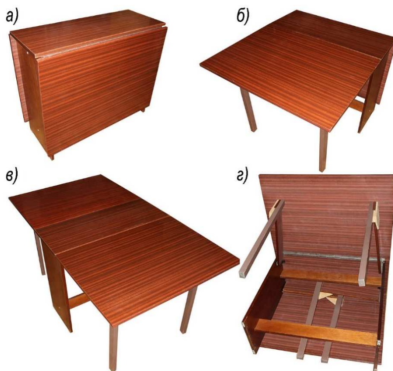
a – в сложенном состоянии; б – в полуразложенном состоянии; в – в разложенном состоянии; г – в полуразложенном состоянии на виде снизу (ненадежные места крепления ножек к горизонтальным царгам усилены пользователем накладками из фанеры)
