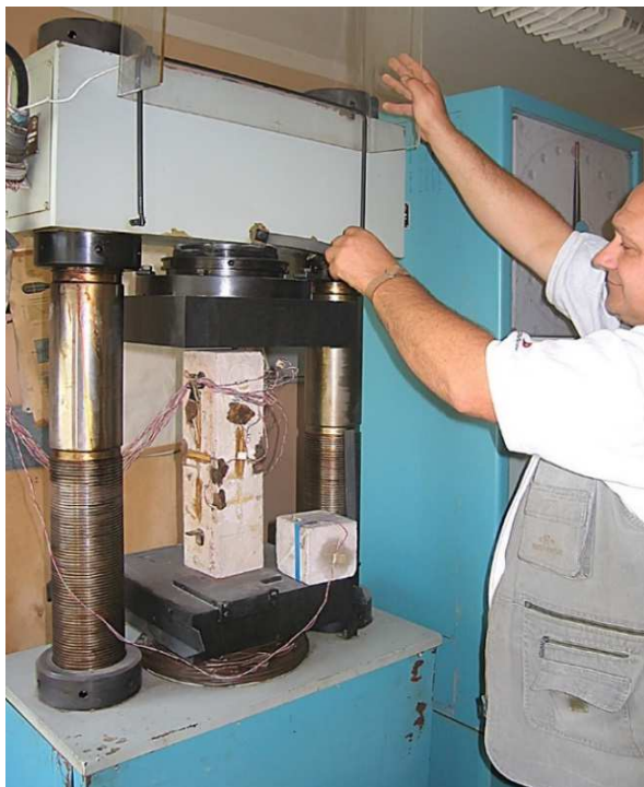
Рисунок 1.11. – Испытание бетонной призмы на сжатие с помощью гидравлического пресса
