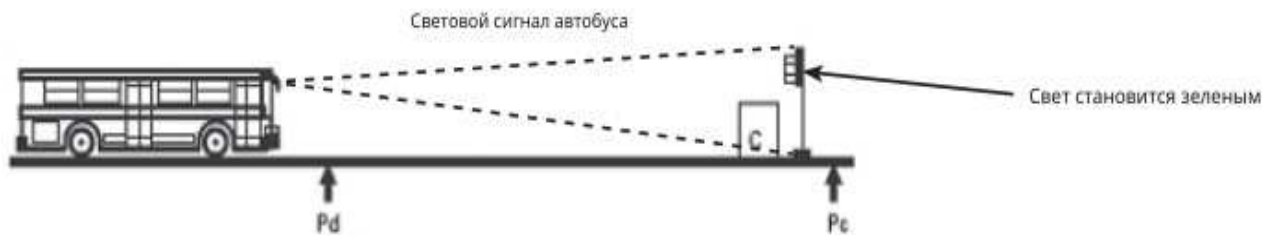
Рисунок 4. – Система управления сигналами светофора [6]
