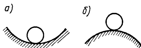
Рисунок 13.1. – К понятию устойчивого и неустойчивого равновесия твердых тел
