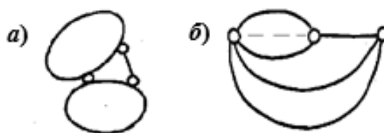
Рисунок 15.9. – Соединения двух дисков при помощи шарнира и стержня
