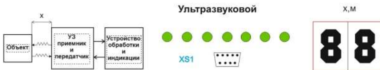
Рисунок 9.12. – Схема подключения ультразвукового датчика линейного перемещения
