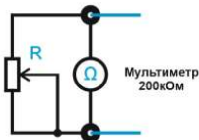
Рисунок 9.9. – Схема подключения мультиметра для исследования резистивного датчика линейного перемещения
