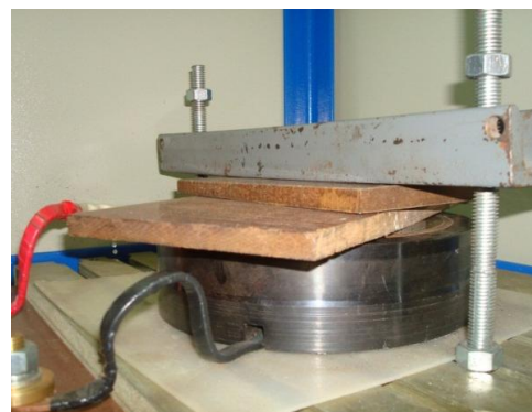
Рис. 4. Общий вид плоского индуктора с крепежным устройством
