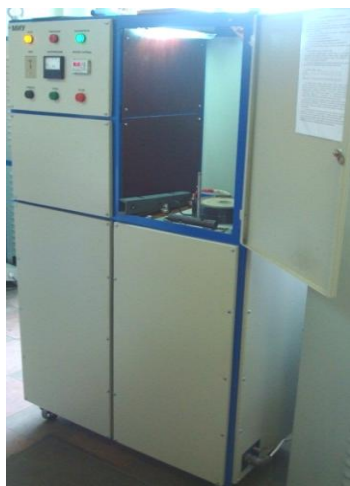
Рис. 1. Магнитно-импульсная установка для упрочнения стальных изделий
