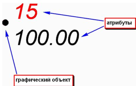
Рисунок 6.17. – Блок с двумя атрибутами
