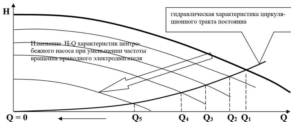
Рисунок 5.2. – Изменение расхода в системе за счет изменения частоты вращения приводного электродвигателя насоса
