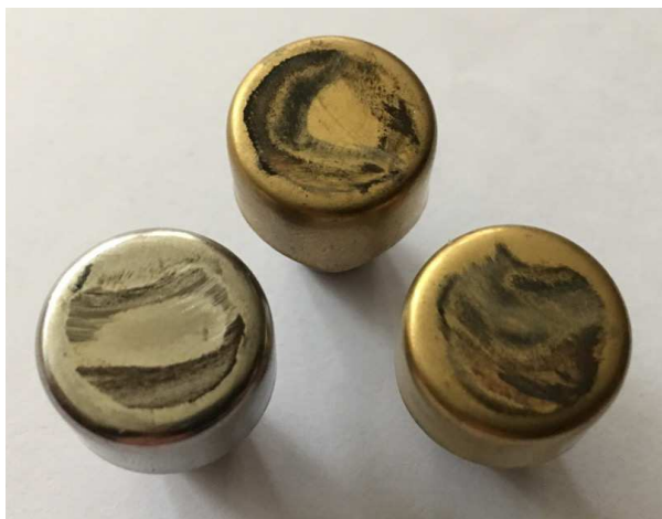
Рисунок 2.22. – Внешний вид образцов после испытания на машине трения при следующих режимах: усилие прижима – 40 Н, скорость – 200 мин -1 , время – 560 с
