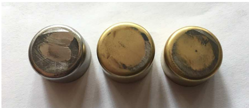
Рисунок 2.27. – Внешний вид образцов после испытания на машине трения при следующих режимах: усилие прижима – 300 Н, скорость – 200 мин -1 , время – 560 с
