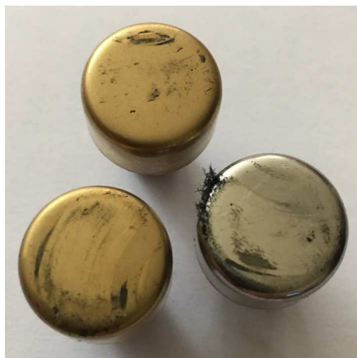
Рисунок 2.21. – Внешний вид образцов после испытания на машине трения при следующих режимах: усилие прижима – 20 Н, скорость – 200 мин -1 , время – 560 с
