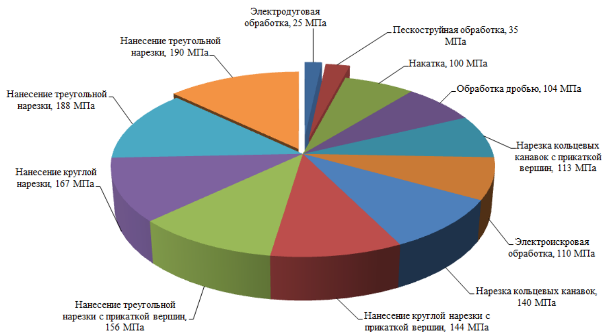
Рисунок 2.2. – Графическое представление данных анализа исследований зависимости прочности сцепления поверхности от различных способов обработки при формировании тонкопленочных покрытий
