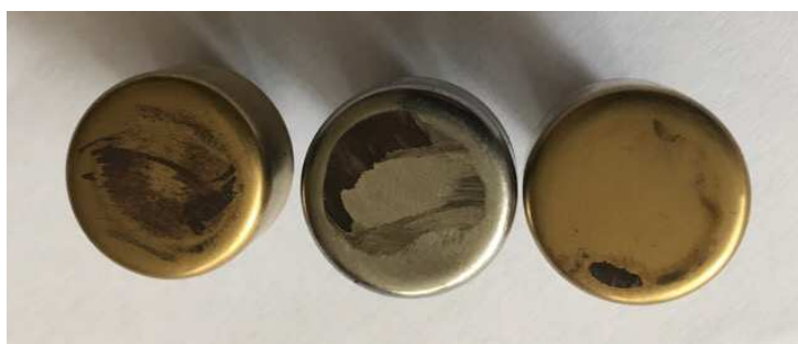
Рисунок 2.24. – Внешний вид образцов после испытания на машине трения при следующих режимах: усилие прижима – 70 Н, скорость – 200 мин -1 , время – 560 с
