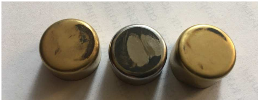
Рисунок 2.26. – Внешний вид образцов после испытания на машине трения при следующих режимах: усилие прижима – 150 Н, скорость – 200 мин -1 , время – 560 с
